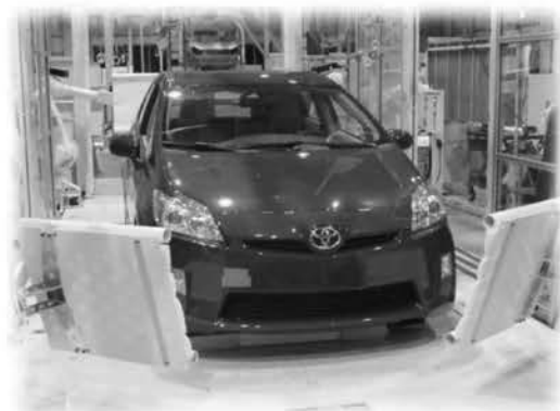
完成車衝突回避支援 検査装置
